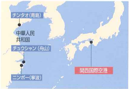
地盤改良に使用した海砂は約2000万m 3 ……一部は中国から大型貨物船で直接搬入しました。
