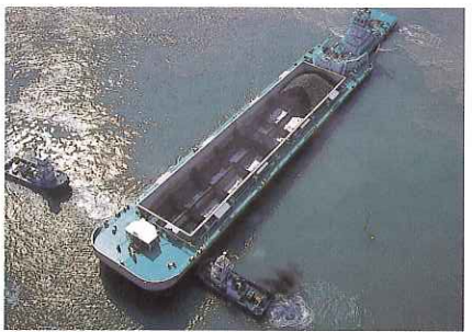
船底が開いて土砂を投入する底開式の大土運船
