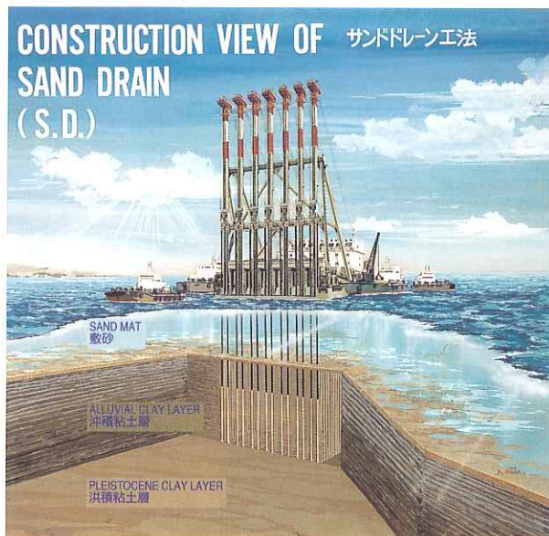
サンドドレーン工法 Sand Drain Method
